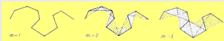
Rys. 7: Własność powłoki wypukłej krzywej B-sklejanej
